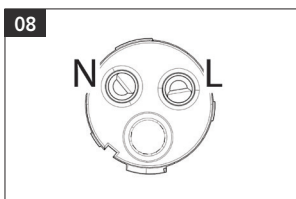
Sluit de kabels correct aan in de kern.
