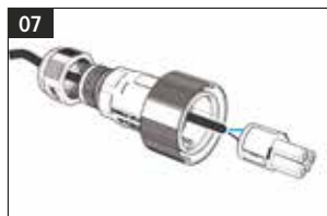
Insérez le câble à travers le presse-étoupe au noyau.
