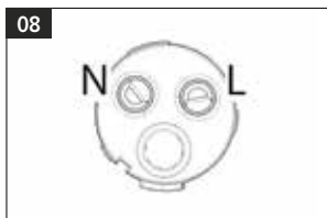
Connectez les câbles correctement au noyau.
